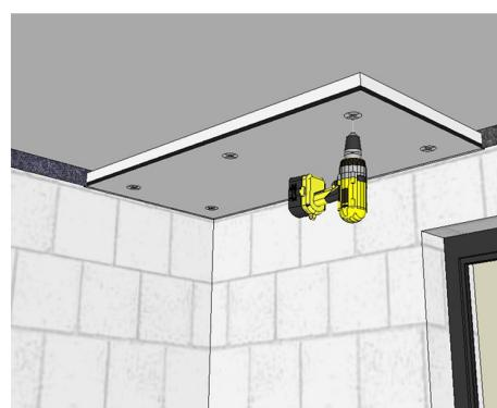
Пробиване на отвори, с помощта на бормашина, за поставяне на дюбелите . Препоръчително е отворите да бъдат на разстояние 10 см от ръба на панела.
