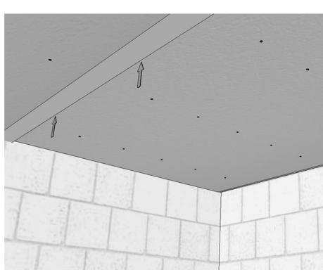
Фугите между отделните гипсокартонени плоскости се шпакловат, като между двата слоя на шпакловъчната маса се слага стъклофазерна лента.
